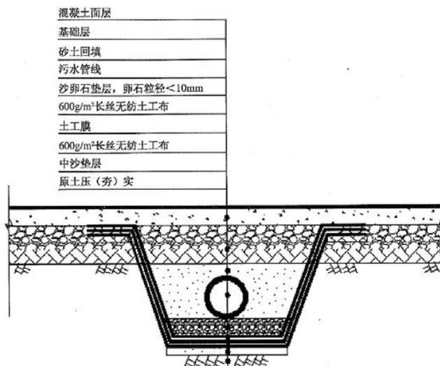
图 8-5 污水管线沟槽典型防渗结构示意图
