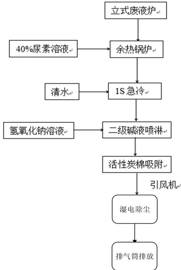
图 8-2 烟气净化流程图
