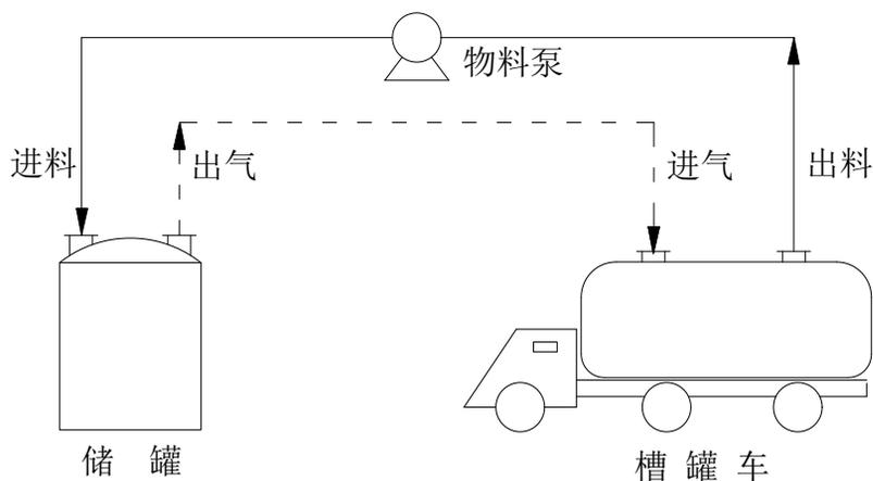
图 7-1 物料进入储罐时的无组织排放控制
