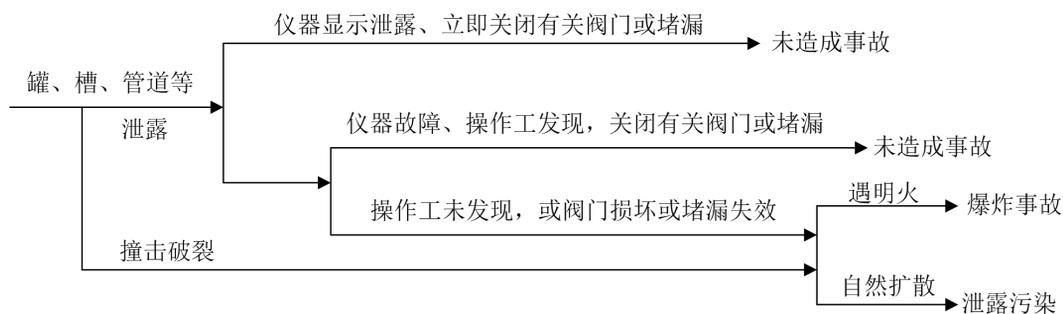
图 7-5 储罐、管道系统事故发生示意图
