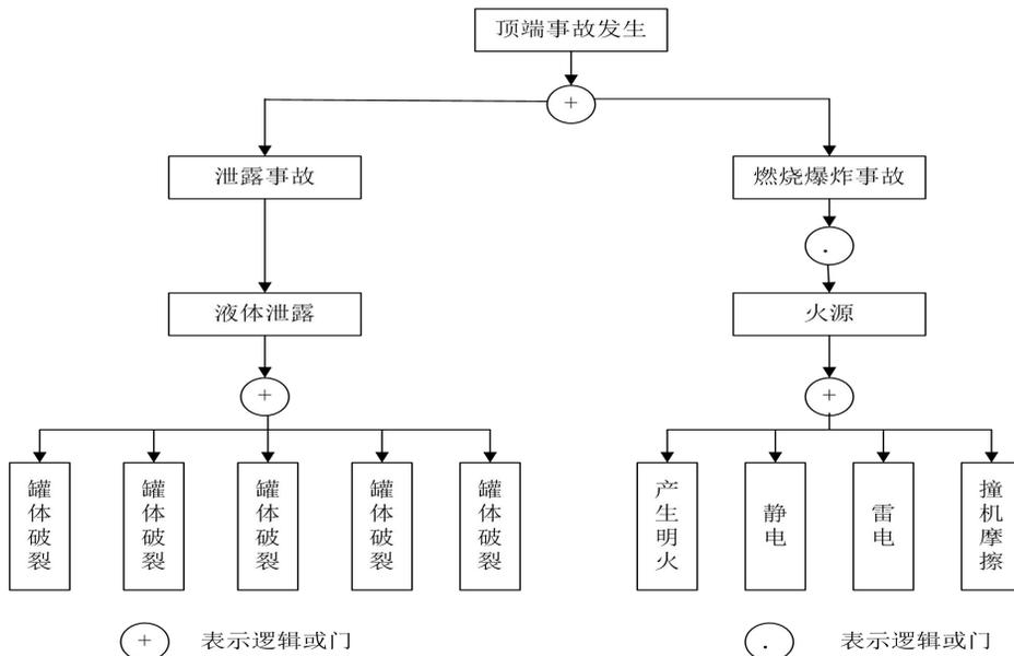
图 7-4 顶端事故发生示意图
