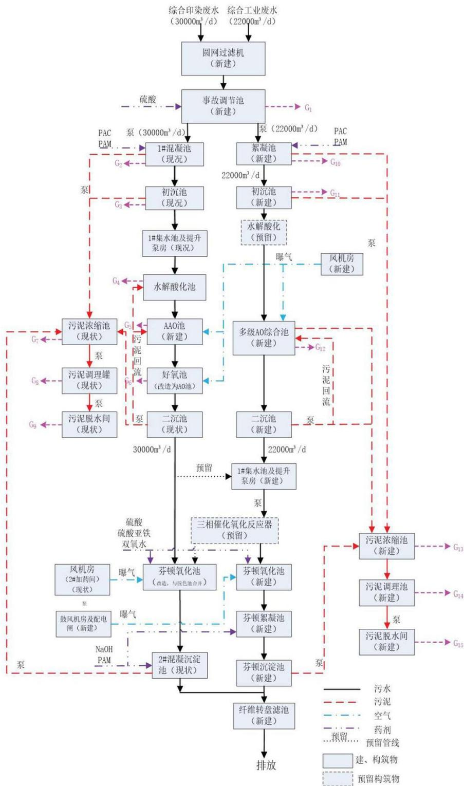
图 6-58 荆州申联环境科技有限公司污水处理厂设计工艺流程示意图
