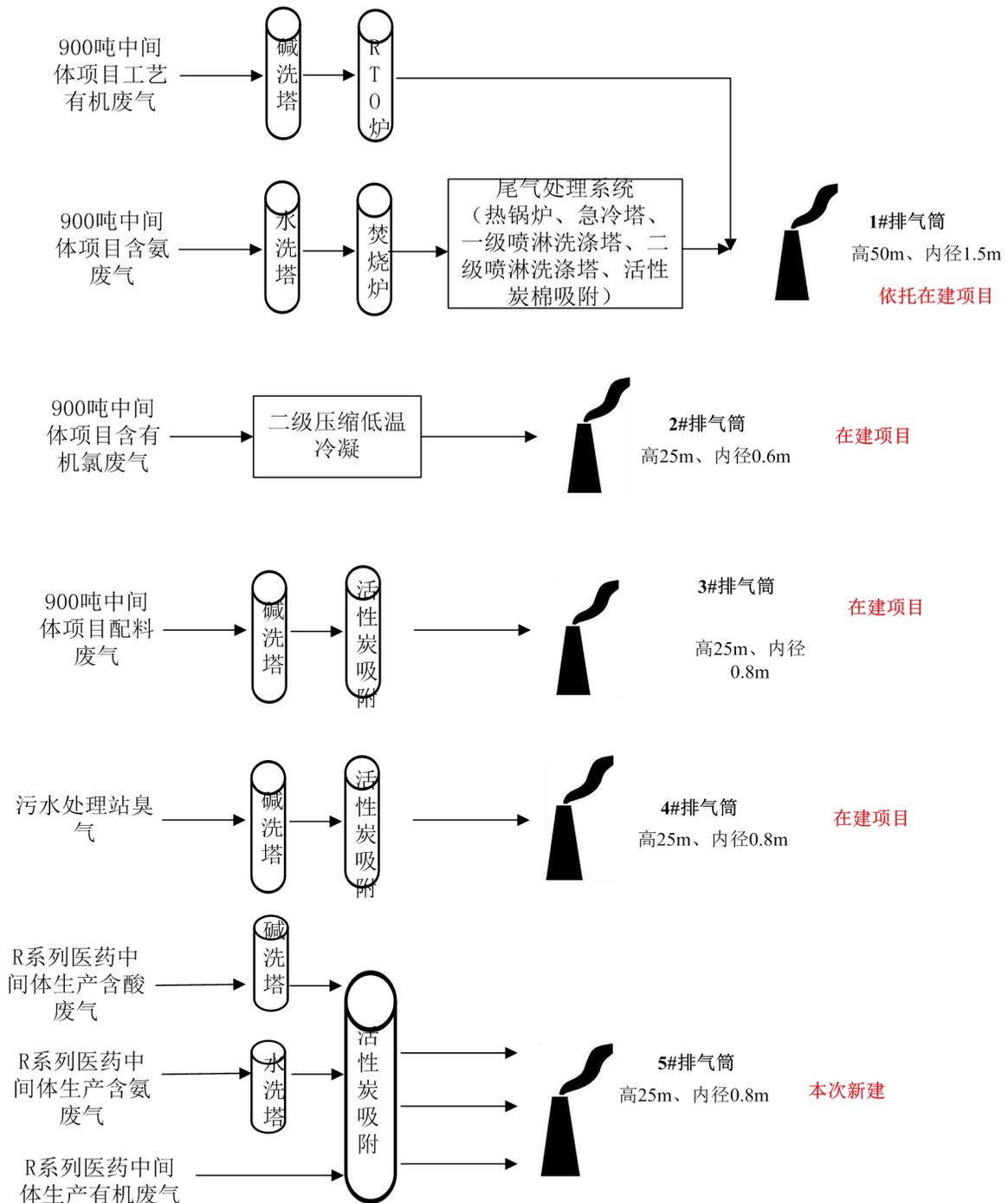
图 8-1 项目建成后全厂废气处置及排放去向示意图
