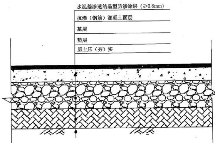
图 8-6 生产车间、仓库典型防渗结构示意图
