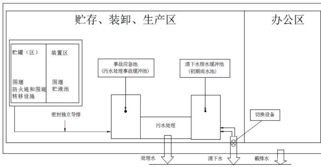
图 7-16 污水三级防控示意图
