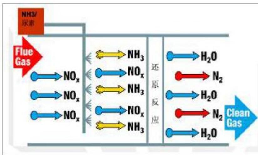
图 8-3 SNCR 脱硝工艺反应原理示意图
