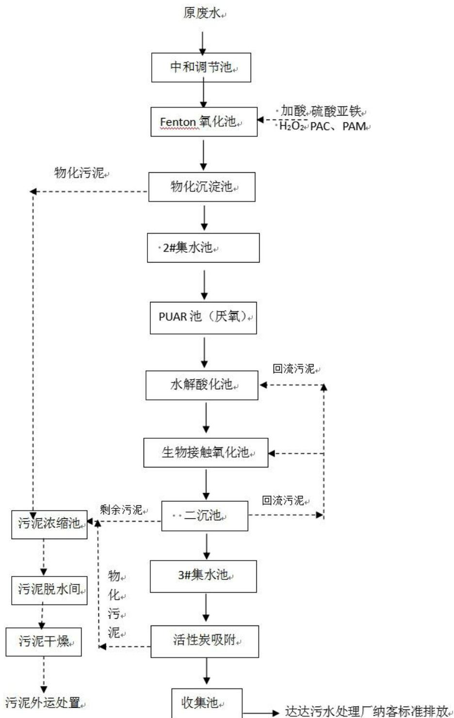
图 8-4 厂区污水处理站处理工艺流程图
